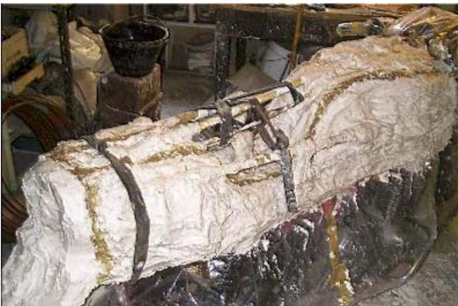
Queste operazioni vanno ripetute per ogni singola parte. A questo punto vi ritroverete di fronte ad un ammasso informe di gesso, una sorta di larva... ma non disperate... ora dovrete aprire il tutto! Per la cronaca: tra le pareti in argilla, l'armatura e la lavorazione del gesso ogni singolo pezzo mi ha occupato per una intera giornata lavorativa
