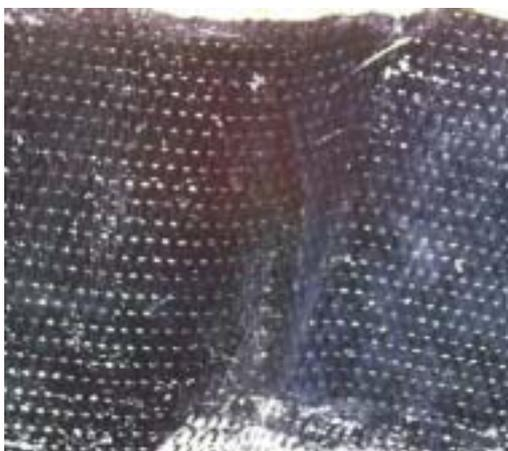
Questa volta però invece della fibra di vetro, per rinforzare ulteriormente la scocca della moto (dato che la si dovrà pure usare) si impregna con la resina poliestere la *fibra di carbonio*.
