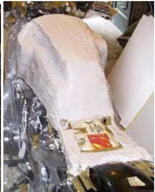
Mentre si posiziona il gesso, prima che avvenga la presa (caratterizzata dallo sviluppo di calore), lo si modella con delle spatole, quando la presa è avvenuta la lavorazione continua utilizzando lime o vecchie grattugie per il formaggio. Dato che il gesso non è ancora essiccato le lime vanno pulite spesso con una spazzola di ferro. Modellate in questo modo il vostro pezzo aggiungendo e togliendo di volta in volta materiale.
