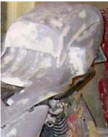
Con lo stucco in fibra di vetro e una spatola da carrozziere, viene rasata tutta la superficie e colmate eventuali bolle d'aria emerse durante la lavorazione. Utilizzando un tampone e della carta vetrata si asporta lo stucco in eccesso livellando il tutto. Per facilitare il lavoro utilizzate una levigatrice elettrica. Queste operazioni sono molto lunghe e andranno ripetute più volte anche sulla stessa zona.
