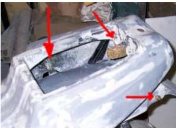
Utilizzando delle squadrette in metallo e inglobandole all'interno della scocca con della vetroresina vengono creati dei punti di ancoraggio con il telaio sottostante, che potranno poi essere fissati con delle viti. Per posizionare le squadrette in modo corretto fissatele provvisoriamente con dello stucco in fibra prima di inglobarle definitivamente.
