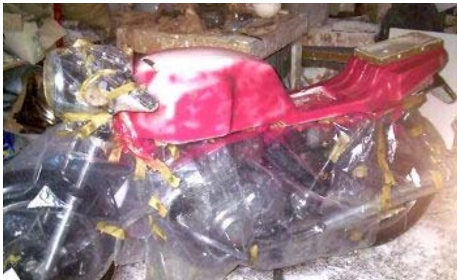
Tutta la scocca in gesso è isolata con smalto e cera. Una volta delimitati i numeri di pezzi si procede con il creare dei tasselli che impediscano il sottosquadro e che si possano sfilare senza problemi.
