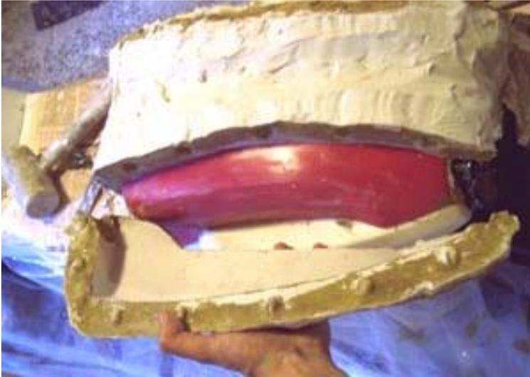
Con uno scalpello da falegname a lama larga, picchiettate sulle linee di delimitazione ma senza forzare. Cercate di far leva su più punti ruotando la lama dello scalpello all'interno della scanalatura creata.
