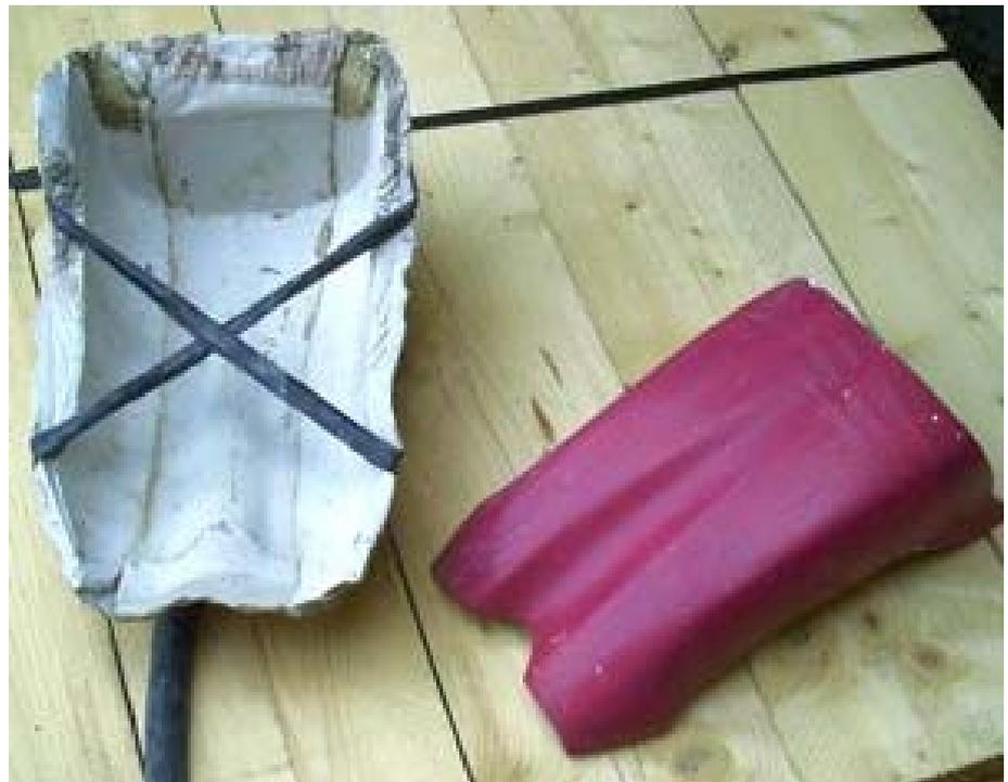
La formatura può essere applicata anche su superfici di grandi dimensioni in questo caso le varie parti che compongono il calco devono essere *armate* con strutture rigide che ne impediscano la rottura durante l'apertura e che permettano di sopportare il notevole peso del gesso.
